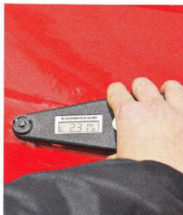
Bestätigung per Lackschichtdickenmesser: Beim rechten Kotflügel bewegt sich diese bereits im satten Millimeterbereich.
