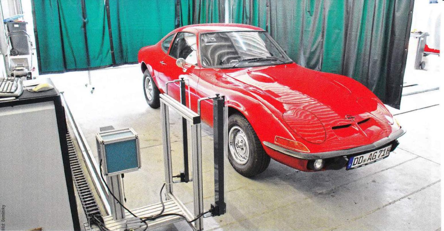
Ein unscheinbares „Fahrgestell“ mit zwei Blitzlampen, eine Infrarotkamera und eine spezielle Software: Mithilfe dieser Werkzeuge lässt sich bei Oldtimern im Handumdrehen unter den Lack blicken. Bunte Farbdigramme legen schonungslos dar, was sich unter der glänzenden Hülle verbirgt.
