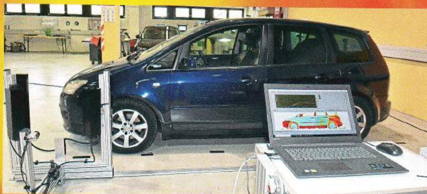
Das Bild vom Thermoscan wird auf den Laptop übertragen und kann dort ausgewertet werden.
