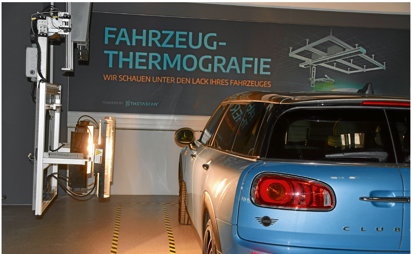
Der vollautomatisierte Thermografie-Scan dauert zwischen 10 und 20 Minuten
